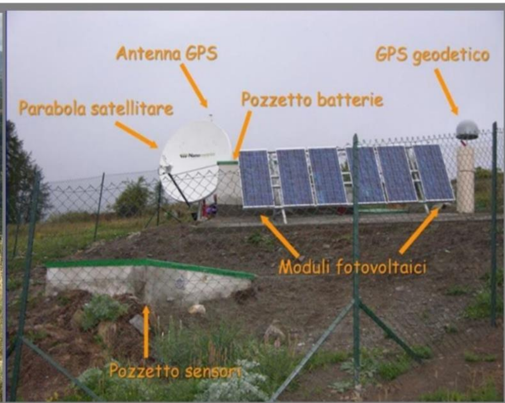
A destra un esempio di stazione multiparametrica della Rete Sismica Nazionale. A sinistra un tripode con l'antenna GPS installato presso la stazione CORL-Corleone (PA).
