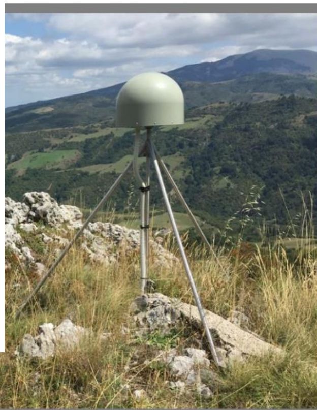
A destra un esempio di stazione multiparametrica della Rete Sismica Nazionale. A sinistra un tripode con l'antenna GPS installato presso la stazione CORL-Corleone (PA).
