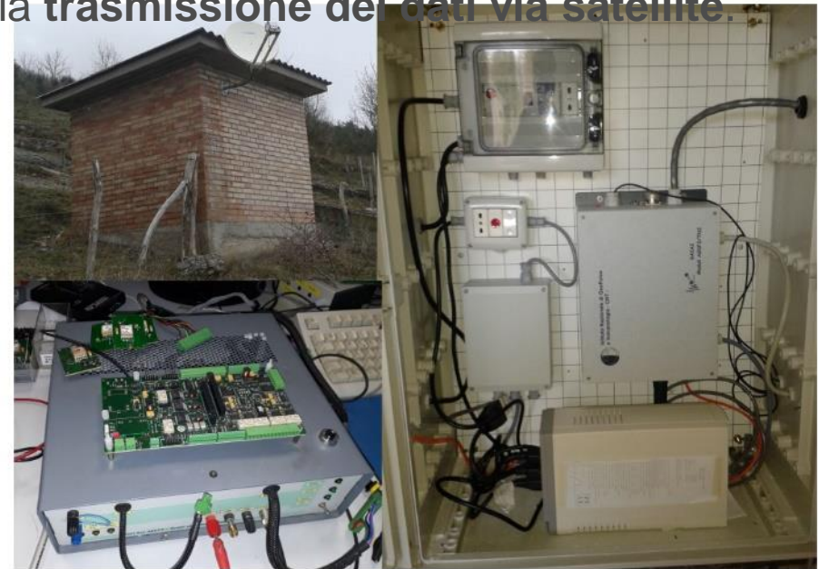
Stazione della RSN di SFI-Santa Sofia (FC): in alto a sx esterno della stazione con la parabola per la trasmissione dati, a dx la strumentazione GAIA, in basso a sx l'apparato, presente nei laboratori INGV di Roma, con cui vengono effettuati i test sugli acquirenti GAIA prima dell'installazione.
